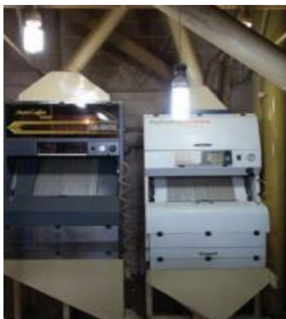
Figura 5. Equipamento de separação dos grãos de cafés beneficiados por cor. Fonte: “Café: Classificação e Degustação”, SENAR, 2017.
